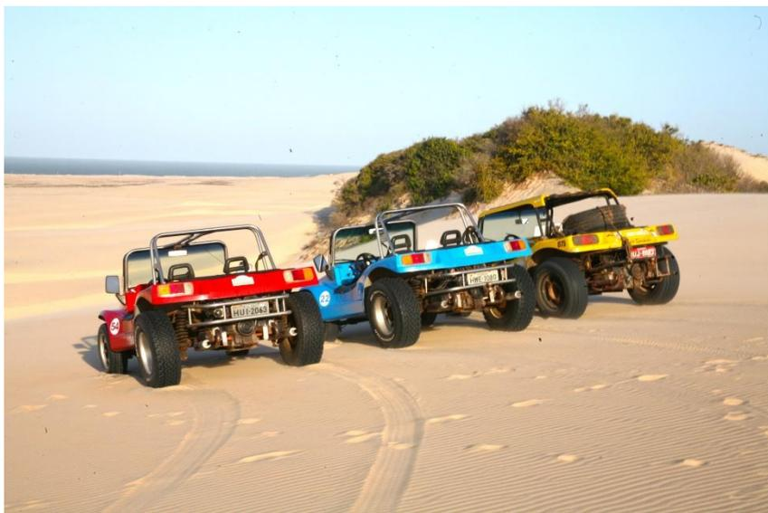
Les buggys Cyber sont composés d'un **châssis tubulaire** sur lequel est boulonné un train avant de coccinelle et un train arrière de Combi VW
